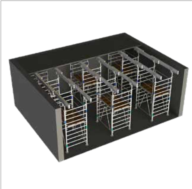
- Abstützung vorgefertigter Hohldeckendecken AL120 auf Gerüsttürmen A120.
